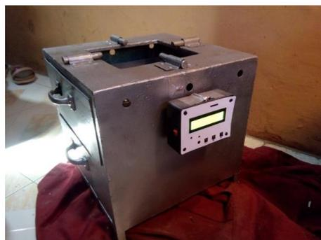
**Gambar 3.** Kompor Briket Portable Dengan Sensor Suhu
